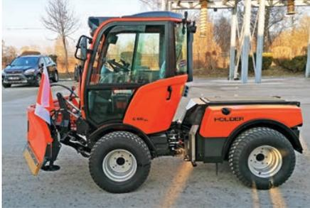
So ist z. B. Mähen in engstem Radius möglich, wo sonst mit der Hand gemäht werden muss. Mit einer eingebauten Absauganlage können die Straßenabläufe ausgesaugt werden, es kann durch Knicklenkung in engsten Kurven gekehrt werden, Grünbewuchs am Gehsteig kann mit dem Holder abgeschnitten und eingesaugt werden und es ist ein Hochdruckreiniger integriert.
