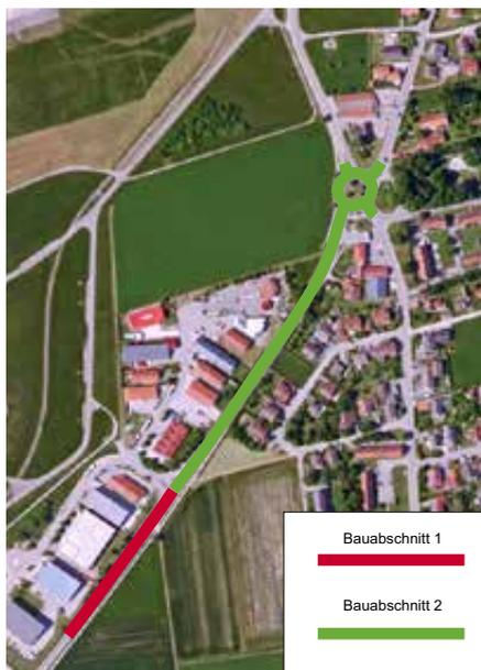
südlich der neuen Lichtsignalanlage bis einschließlich des Kreisverkehrs neu zu asphaltieren. Für die Sanierung wird die alte Fahrbahndecke abgefräst und durch eine neue, lärmärmere Deckschicht ersetzt. Im Bereich des Kreisverkehrs werden mit Erneuerung des Asphalts die Spurrillen beseitigt und die Pflastersteine zu einem Großteil ausgebaut, was ein deutlich geringeres Abrollgeräusch zur Folge hat.
