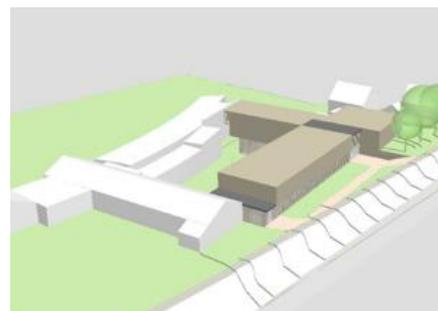
Untergeschoss im Hang: „Sockel“ in Stahlbetonbauweise; Erdgeschoss und Obergeschoss: vorgefertigte Holzelemente
