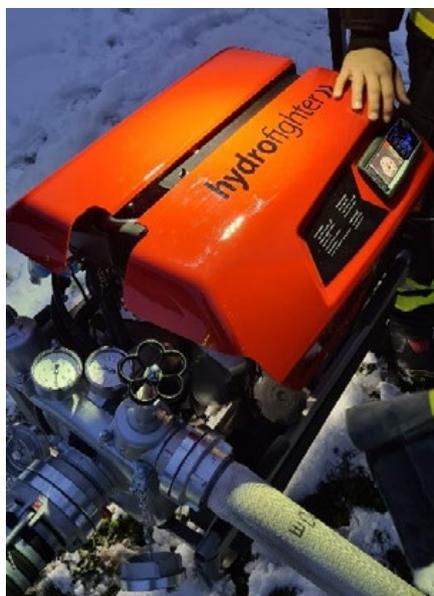
Unsere neue Tragkraftspritze (zum Fördern von Wasser aus dem Gewässer oder aus einem Hydranten)
