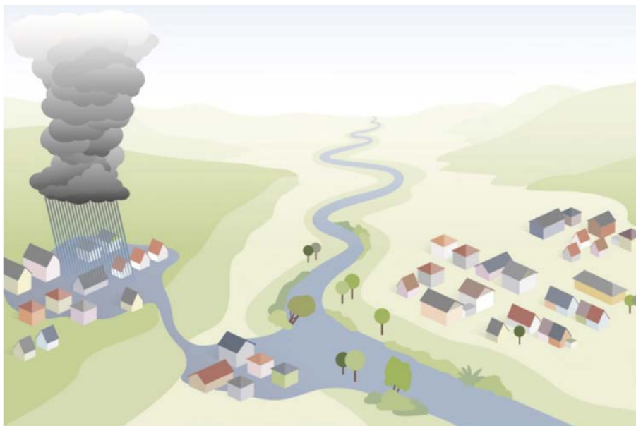
Ein kleinräumiger Starkregen kann auch wild abfließendes Wasser fern von Gewässern verursachen.
